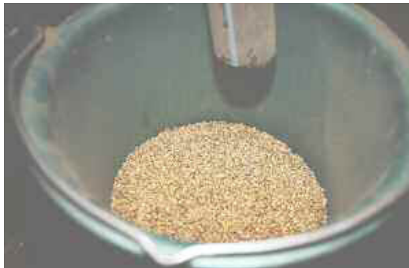
Med en automatisk provtagare ramlar det ut ett representativt prov i hinken varje timme.
